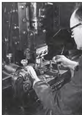
▼ Fig. 17 : Découpe d'un bracelet à la presse.
